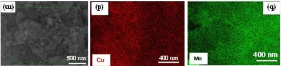
Նկ. 8. Mo-Cu կոմպակտ նմուշի միկրոկառուցվածքը (ա) և նմուշում տարրերի բաշխվածությունը (բ-գ)
