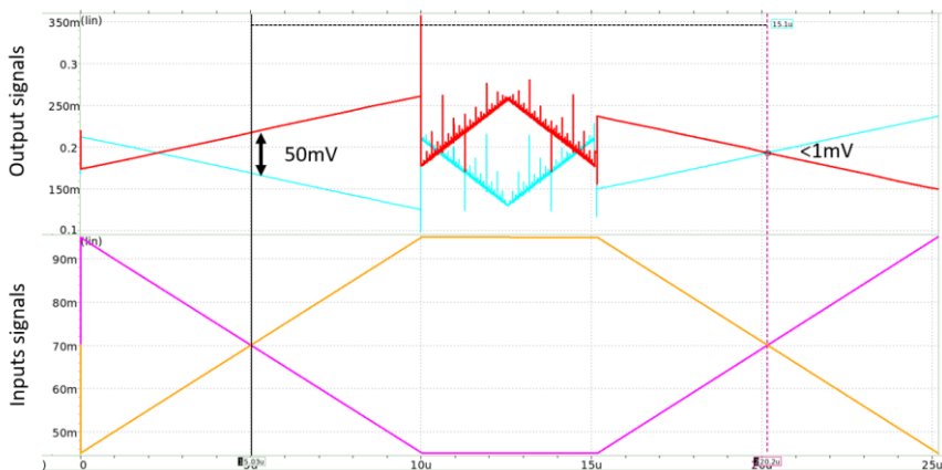
Рис. 7. Напряжение смещения до и после процесса калибровки
